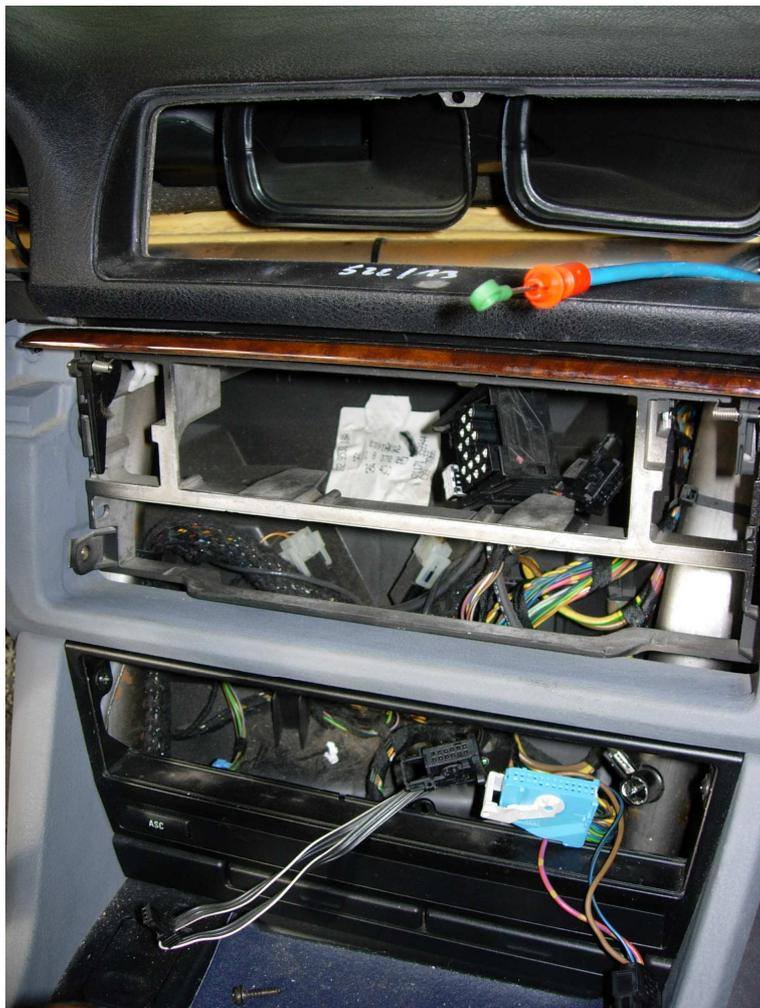
Déposer l'enjoliveur de combiné comportant les boutons d'allumage de feux vis torx en haut et vis derrière les inserts noirs/bois/alu, puis tirer vers soi et débrancher les différents interrupteurs.
