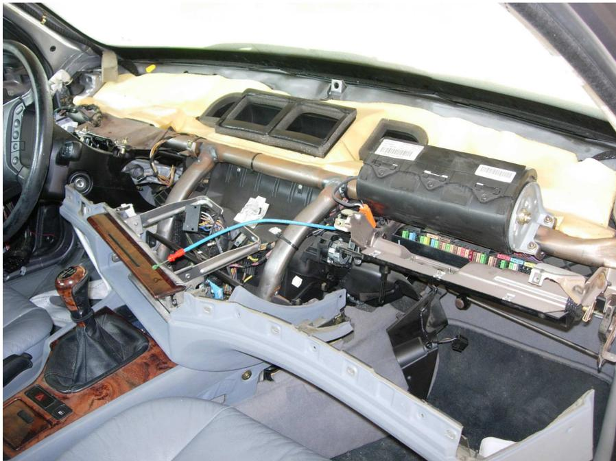
Déposer les 2 vis de fixation des sangles d'airbag rideau (une à l'AV côté planche de bord, une à l'AR vers la poignée AR)
